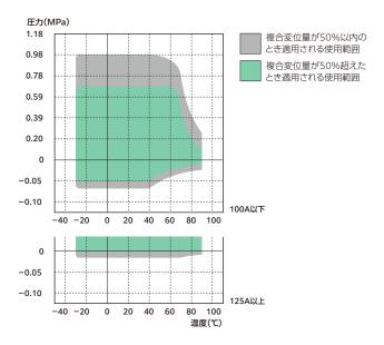
使用圧力:0.98MPa(10kgf/cm²)以下 負 圧:100A以下 -0.07MPa(-0.7kgf/cm²)以上 125A以上 -0.01MPa(-0.1kgf/cm²)以上 使用温度:-30℃~+90℃(冷温水)
